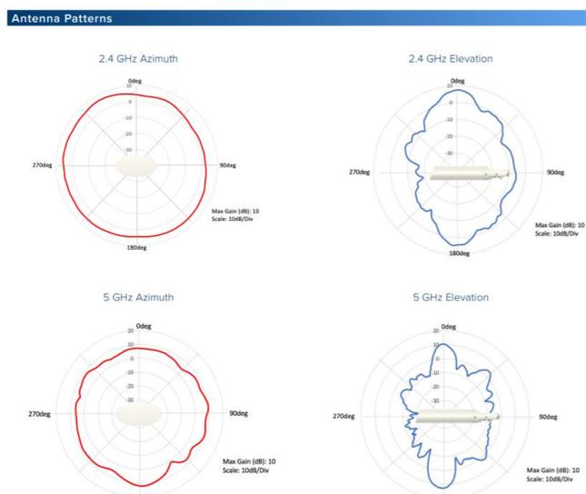
Рис.15 Диаграмма направленности антенны точки доступа Outdoor Wi-Fi 6 XV2-2T0.
