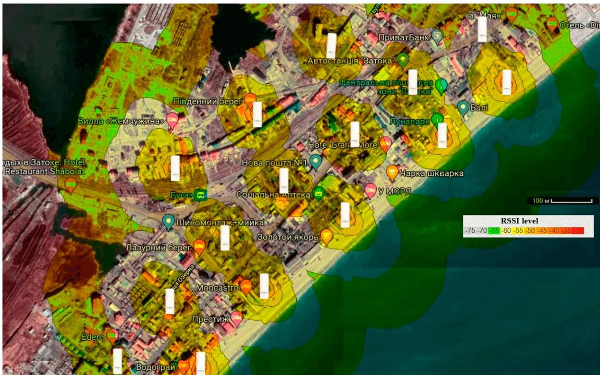
Рис. 17 План покрытия сети Wi-Fi Hotspot доступа в Интернет курортного поселка.
